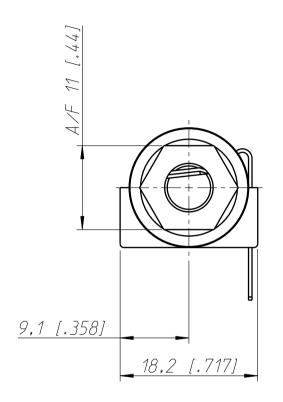
Frontplattenausschnitt (Rückseite) Panel cut out (rear side)
